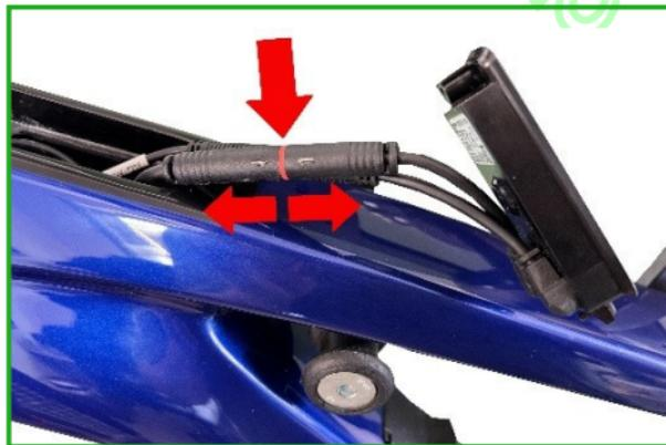
8. Die beiden längeren Kabel am Tuning müssen durch den Rahmen nach unten zum Motor geführt werden. Die Kabelführung sehen Sie anhand der Pfeile. Für diesen Schritt ist eine Kabeleinzughilfe notwendig. Diese wird am besten von unten am Motor in den Rahmen geschoben. Dies ist ohne Ausbau des Motors möglich.
