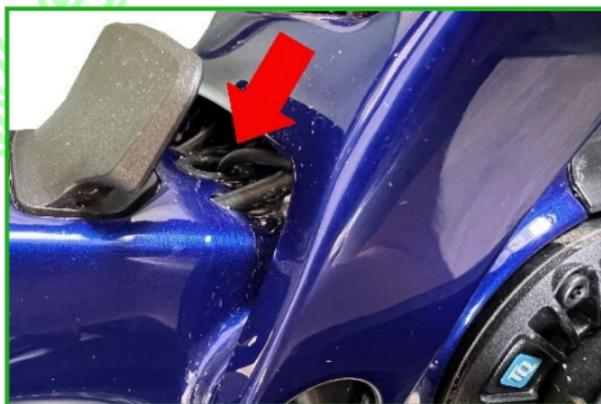
Die Steckverbindung zum Geschwindigkeitssensor wird vorne am Motor benötigt. (siehe erstes Foto Schritt 5)
