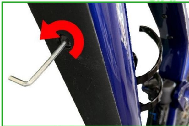
4. Ziehen Sie den Akku nach unten aus dem Rahmen. Danach lösen Sie die beiden Schrauben der Kabelabdeckung hinter dem Akku mit einem Torx T15. Ziehen Sie die Abdeckung nach unten heraus.
