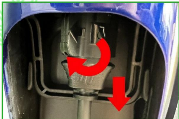
3. Lösen Sie die obere Befestigungsschraube des Akkus. (ebenfalls mit einem Inbus Größe 4)
