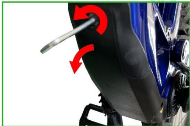
2. Unterhalb der Abdeckung finden Sie die Steckverbindung zum Akku. Lösen Sie diese, indem Sie den Bajonett-Verschluss gegen den Uhrzeigersinn drehen und den Stecker dann nach unten abziehen.
