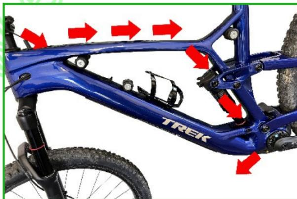
Binden Sie die beiden Steckverbinder des Tuning an die Einzughilfe und ziehen diese vorsichtig durch den Rahmen nach unten zum Motor.
