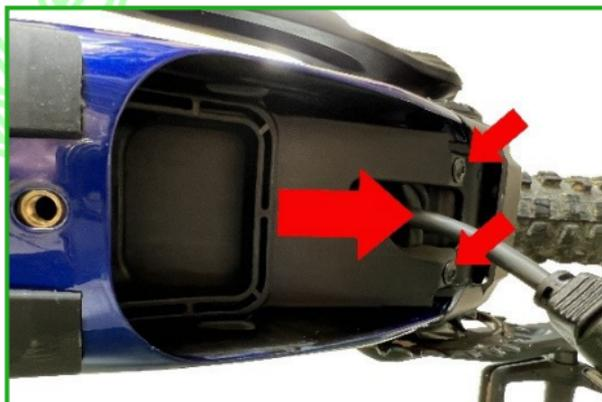
5. Suchen Sie die Steckverbindung zum Geschwindigkeitssensor. Diese ist schwarz, rund und hat ca. 5mm Durchmesser.
